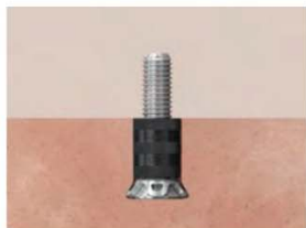
Монтаж анкера FZP II врівень з тильної поверхні фасадної панелі з каліброваного каменю
