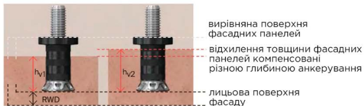
Дистанційний монтаж за допомогою анкера FZP II SO в панель з некаліброваного каменю
